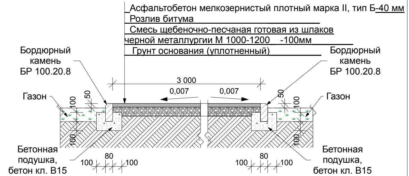
Сечение 2 - 2 (примыкание асфальтобетонного покрытия пешеходного тротуара к дому)
